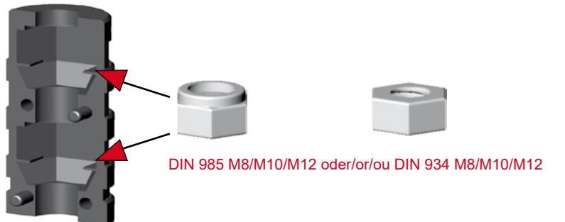
Stufenbohrungen im Rohr
