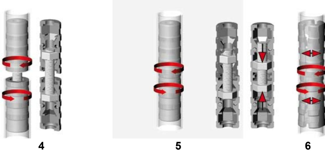
**Anschluss Expanderverbinder an Traversen mit 1 Durchgangs- und 1 Sackbohrung**
