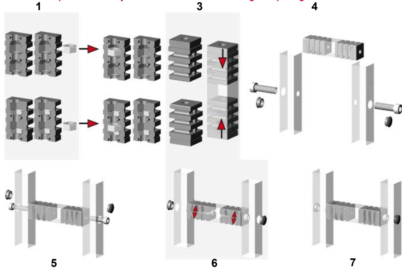
**Anschluss Expanderverbinder an Traversen mit 1 Durchgangs- und 1 Sackbohrung**
