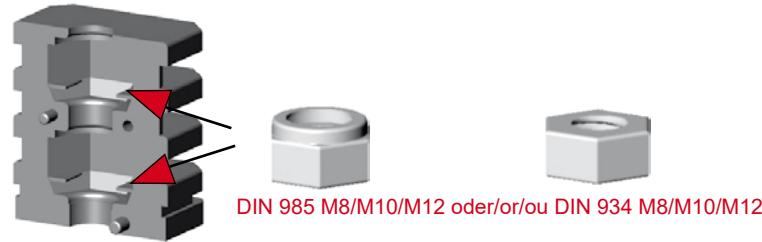
Stufenbohrungen im Rohr
