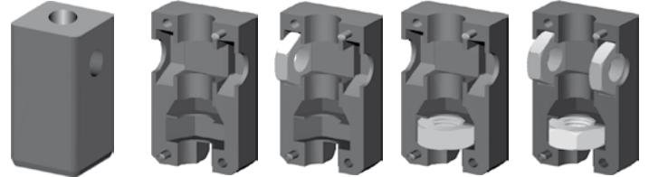
ohne Bund, Querverbindungen in **einer** Ebene und **zwei** Richtungen, Längsverbindung möglich
