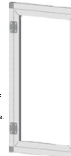
Wegen der Fertigungstoleranzen für Profile und Steckverbinder können auf Gehrung geschnittene Profilsteg ein Spaltmaß von bis zu ca. 1 mm aufweisen.
