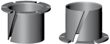
Leicht zu montierendes Clips-Gleitlager. Der schräge Schlitz gleicht Toleranzen der Aufnahme aus, ermöglicht geringes Lagerspiel und sorgt für einfache Montage.
