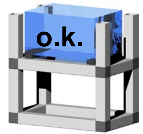
weiche Unterlagen nur im Bereich der Verbinderzapfen soft pads in the area of connector cones only embases souples limitées aux zones tiges des raccords
